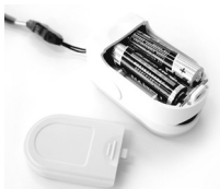
Figur 3. Installation av batterier
